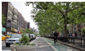
FARGET SYKKELFELT INNTIL GATEPARKERING MED SIKKERHETSSONE OG AVGRENŚNING MED PULLTER
