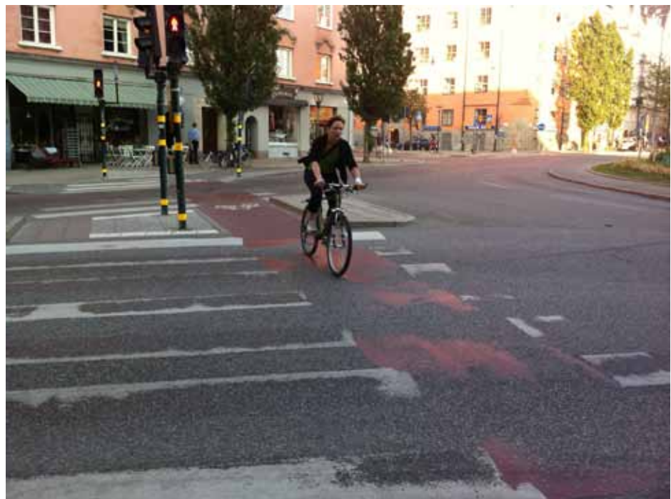
Figur. Cykelöverfart vid cirkulationsplats. Denna placering rekommenderas inte av holländska CROW, de vill att cykelöverfarten ska ligga 5 meter från cirkulationsplatsen.
