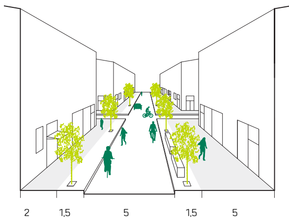
Sektion med exempel på stadsgata (40 km/h) från Trafiknätsanalys av Linköpings innerstad (Spacescape 2016).
