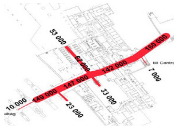
GÅNGFLÖDEN STOCKHOLM CENTRALSTATION 2014 Efter Citybanan minskade flödena med 43% i tunnelgången.
