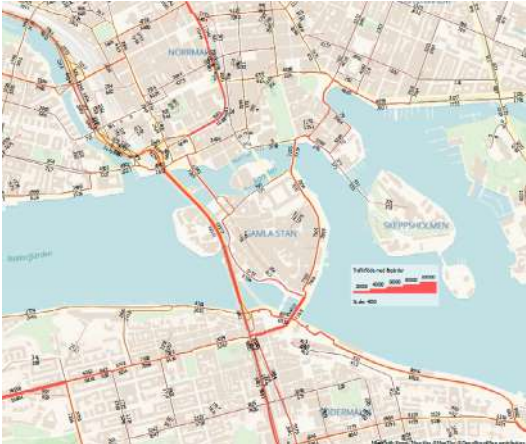
Dygnsflöden vintervardagsmedeldygn med implementerade åtgärder (M4Traffic)
